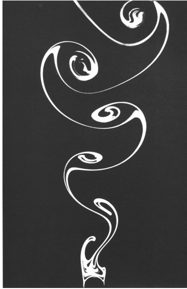
Figura 25: Scia di vortici in laboratorio.
